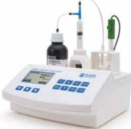
Fig. 5A Hanna titrator for potentiometrisk bestemmelse for total syre og sulfit
