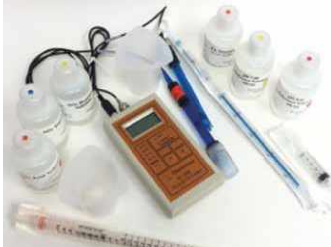
Fig. 5B Vinmetrica titrering udstyr for amperimetrisk bestemmelse af total syre og sulfit
