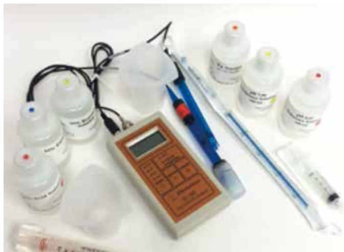
Fig. 5B Vinmetrica titrering udstyr for amperimetrisk bestemmelse af total syre og sulfitt
