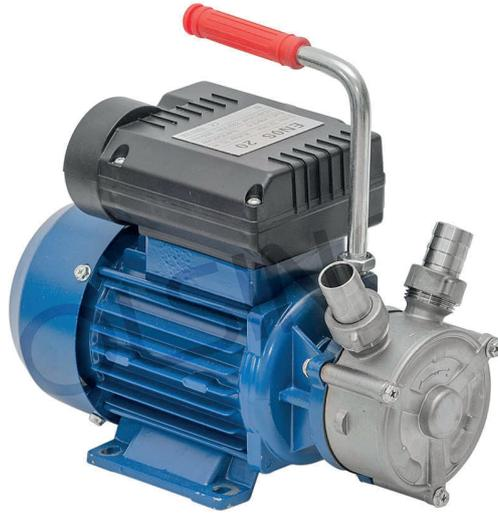
Le pompe ENOS con corpo pompa e girante in acciaio inox AISI 304 sono la soluzione più semplice e veloce per il travaso di liquidi filtrati sia di tipo alimentare che non. Si tratta di pompe centrifughe ad anello liquido laterale, dotate di una capacità di aspirazione fino a 6 metri, e la possibilità di lavorare in presenza di liquidi discontinui. Tali caratteristiche rendono questa pompa idonea all'impiego in numerosi settori, quali: nautica, giardinaggio, agricoltura e enologia.
