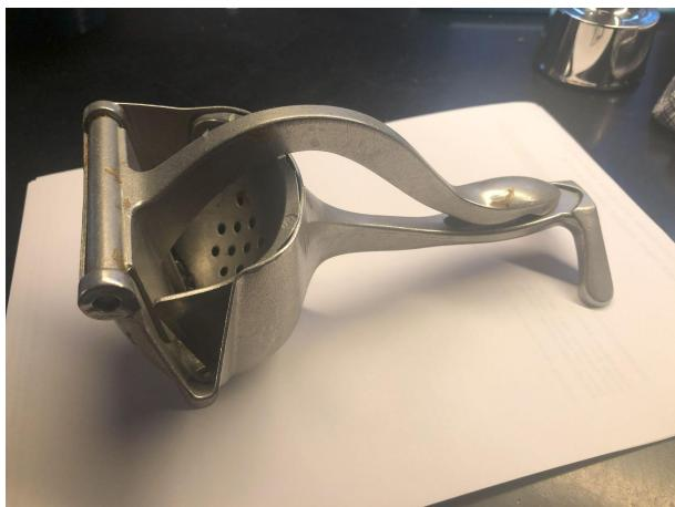
Denne figur viser den druepresser, som er brugt til at presse druemosten ud. Den bruges ved at løfte metalplade op, så lægges druerne i metalskålen med huller i, som fungere ligesom en si. Så presses metalpladen ned, og pressen mosten ud, uden at få skræl og kerner med, dog kan små dele af frugtkødet presse ned i druemosten, derfor centrifugeres mosten efter nedfrysning og inden analyser i 20 min ved 3000 rpm i en Hereus bordcentrifuge.
