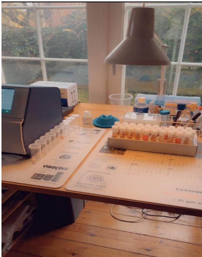
Her ses et billede af forsøgsopstillingen af målingerne på Oenofoss. I reagensglassene opbevares druemosten. 5 mL most suges op via en probe, hvorefter mosten transportereres gennem et rør hen til en pumpe der pumper 0,83 mL væske op af 6 omgange i et kammer hvor efter de mellem 2500- 25.000 nm bølgelængder sendes igennem og detektor omformer lys intensiteten til et elektrisk signal, som kan læses på displayet. (**se bilag 10-16**)
