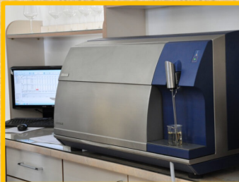
FOSS WineScan FTIR-SO2 er kun kalibreret til druevinanalyser
